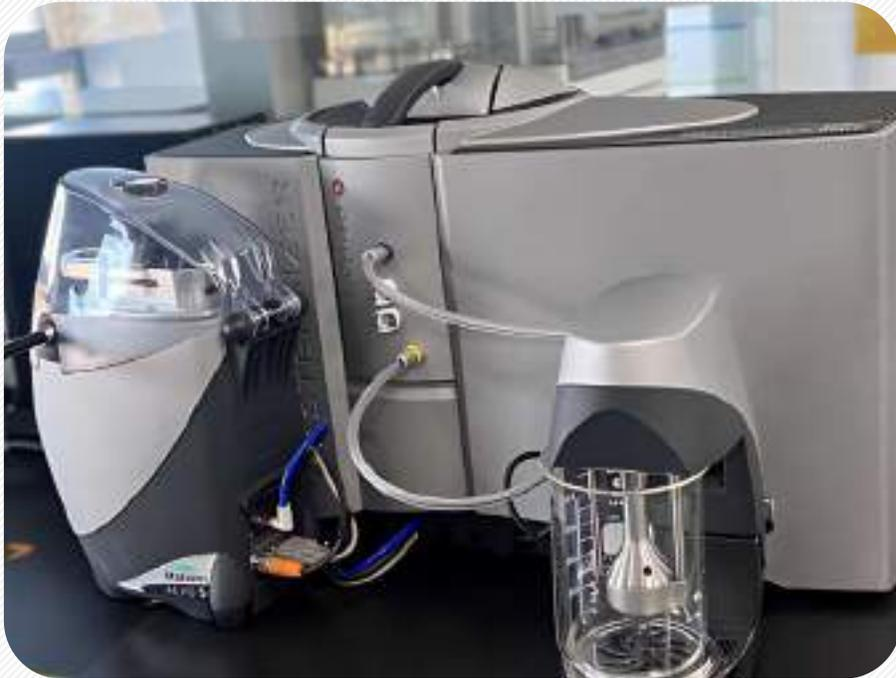
レーザー回折粒度分布測定装置
