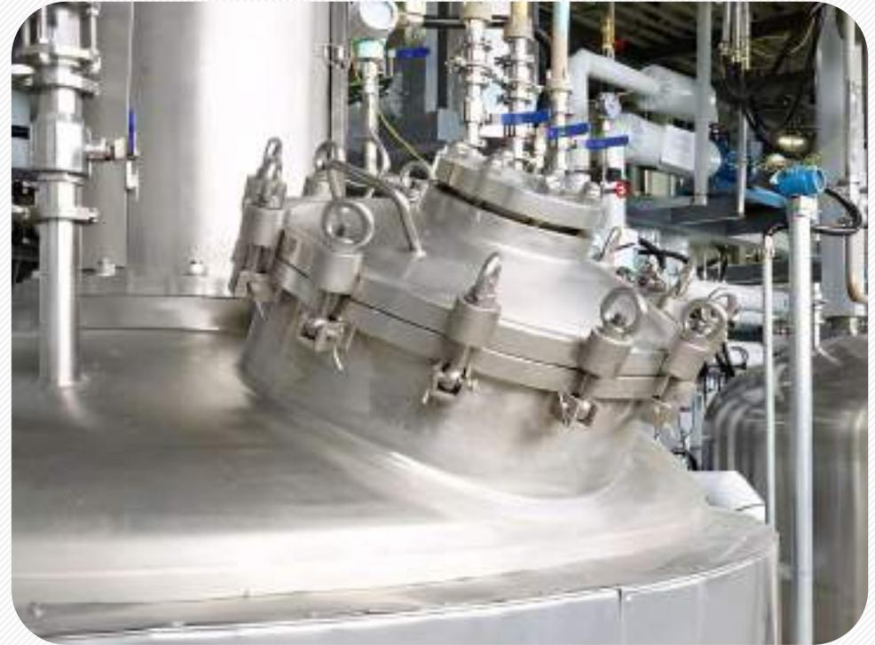
50Lから500Lまでの複数のハステロイ反応釜で超低温、強酸反応が実施可能
